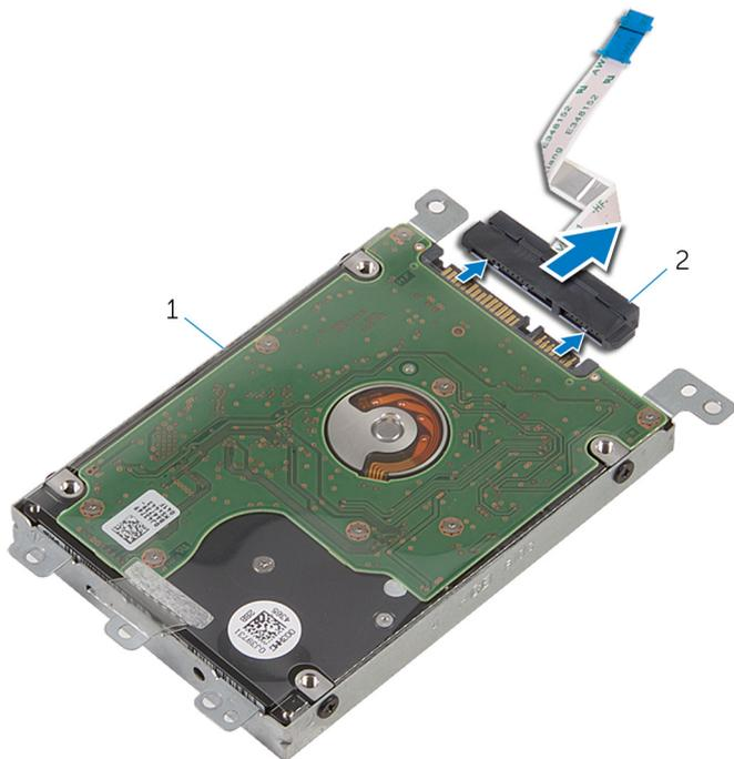
1 Ensamblaje de la unidad de disco duro
